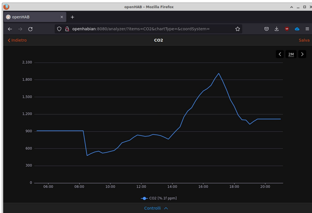
Figura 6: Cruscotto di OpenHAB che mostra il grafico giornaliero della CO 2 rilevata.
